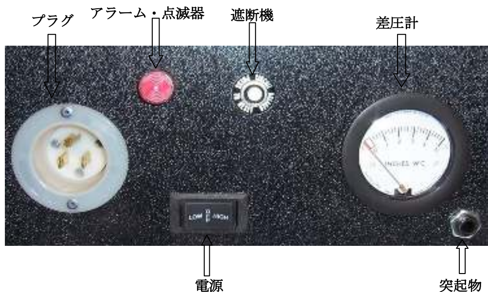
F1002 のコントロールパネル
